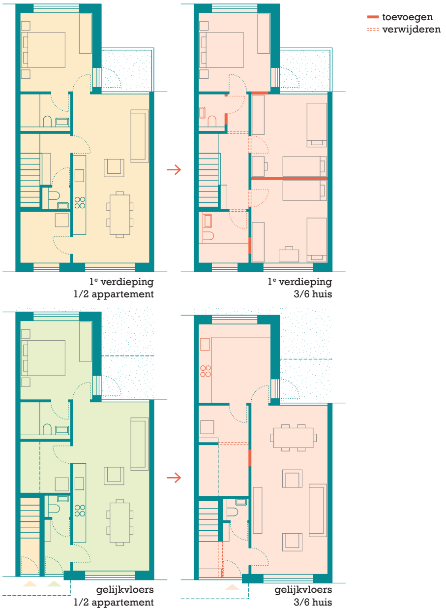
Figuur 5. Ontwerp van appartementen die kunnen worden omgebouwd tot eengezinswoning. De locatie van trappen en technische voorzieningen is zo gepland dat deze eenvoudig kan worden aangepast.
